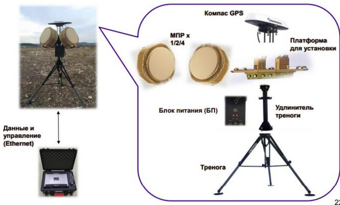
Рисунок 1. Многофункциональная РЛС разведки огневых позиций стреляющих минометов и наземных подвижных целей «Платформа»
