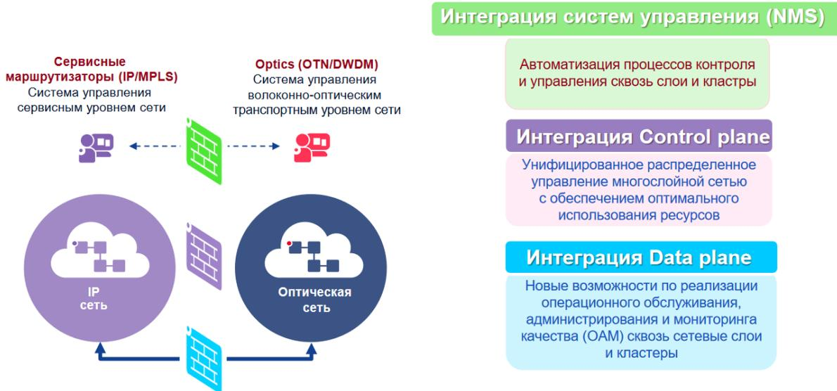
Рис. 6 – Эволюция от классических систем управления сетью (NMS) к программно-определяемой сервисной платформе (Carrier SDN)
