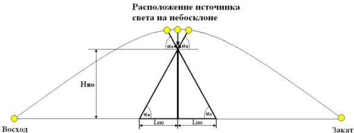
Рис.5. Принципиальная схема определения высоты объекта по его тени в зависимости от расположения источника света на небосклоне при условии падения луча света на объект под углом к горизонту большим 45^\circ
