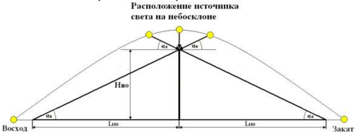
Рис.4. Принципиальная схема определения высоты объекта по длине его тени в зависимости от расположения источника света на небосклоне при условии падения луча света на объект под углом к горизонту меньшим 45^\circ
